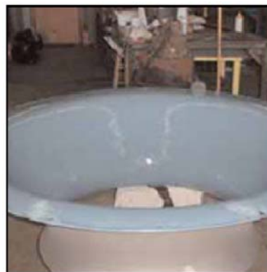
Avslutad beläggning av fläkthus
