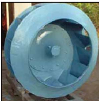
Beläggning med två skikt Belzona® 1341
