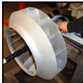
Fläkthjul blåstrat och klar för beläggning med Belzona ® 1341.
