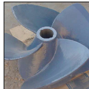
Färdig impeller efter en sista beläggning med Belzona® 1321
