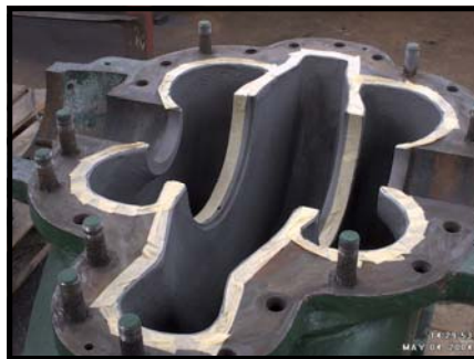
Efter blästring och reparation med Belzona® 1111.
