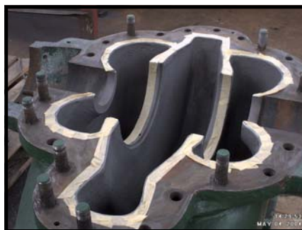
Efter blästring och reparation med Belzona® 1111.
