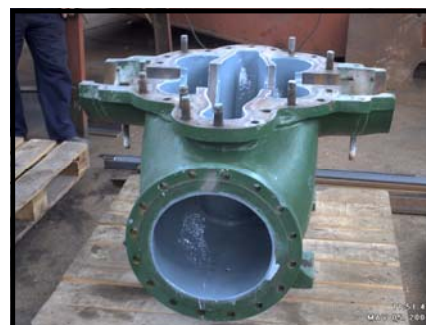
Bild på färdig pump efter helbeläggning med Belzona® 1341 i två skikt.
