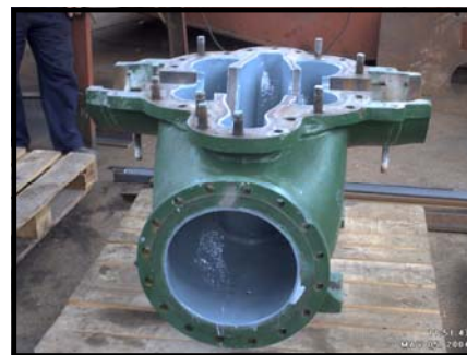
Bild på färdig pump efter helbeläggning med Belzona® 1341 i två skikt.
