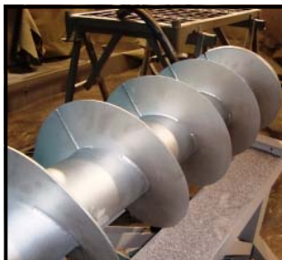
Ny rostfri Allweiler slamskruv under blästring.
