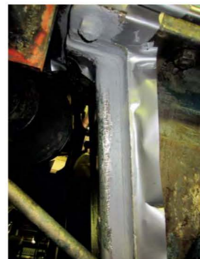
Efter maskering läggs först ett spackel på skarven som ska tätas.
